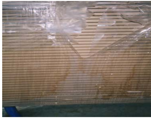
Bild 6 Kondens (fritt vatten) innanför plasten
